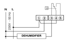
EXAMPLE OF ELECTRICAL CONNECTION FOR A HUMIDIFICATION SYSTEM
